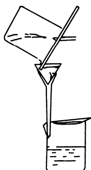
图 1-20 最后少量沉淀的转移
